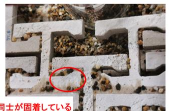
さや型ブロックは、砂地盤より、砂礫混合地盤においてより変状しにくく、より高い効果を発揮する。しかし、ブロックの下に隠れた洗掘孔の発見が難しいなど、維持管理上の課題が考えられる。
