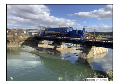
上図：保守車両を用いた繰返し載荷試験(JR東日本撮影) https://twitter.com/JRE_Tohoku_Akita/status/1600734622408507392?r=20 より引用
