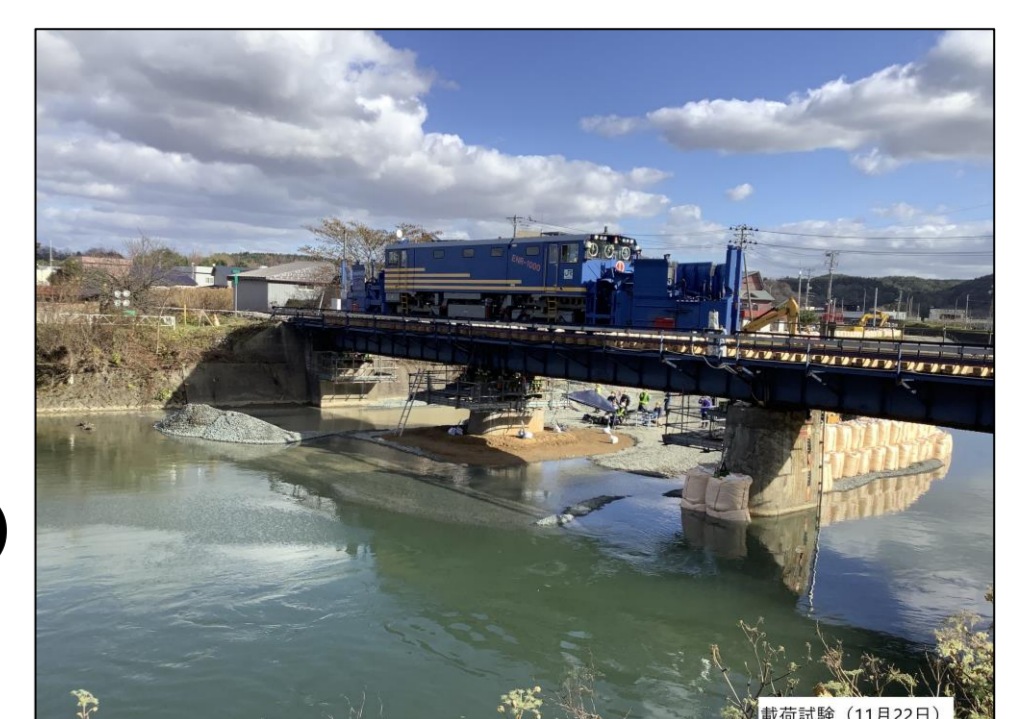
上図：保守車両を用いた繰返し载荷試験(JR東日本撮影)
