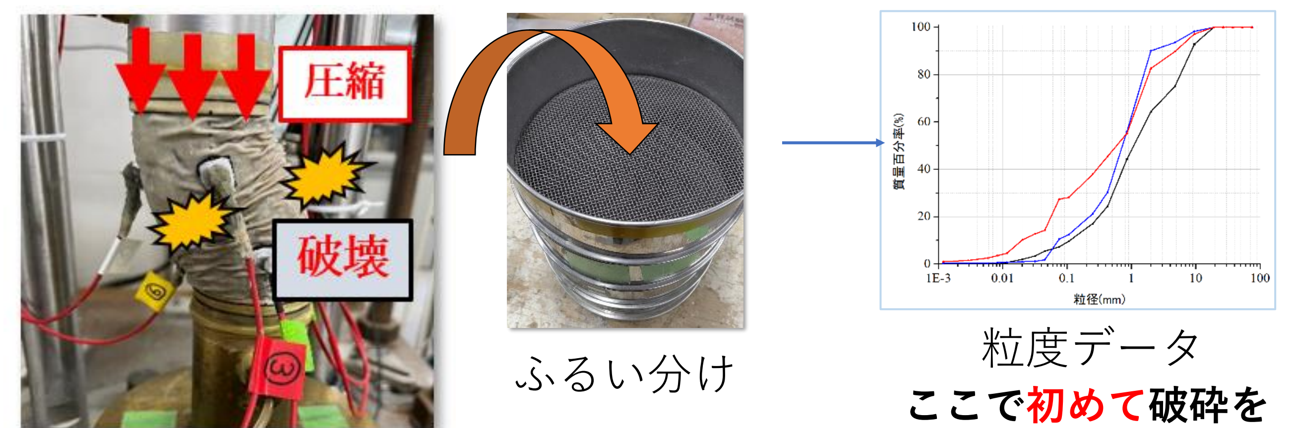
三軸圧縮試験を行いその後供試体は解体・分析
