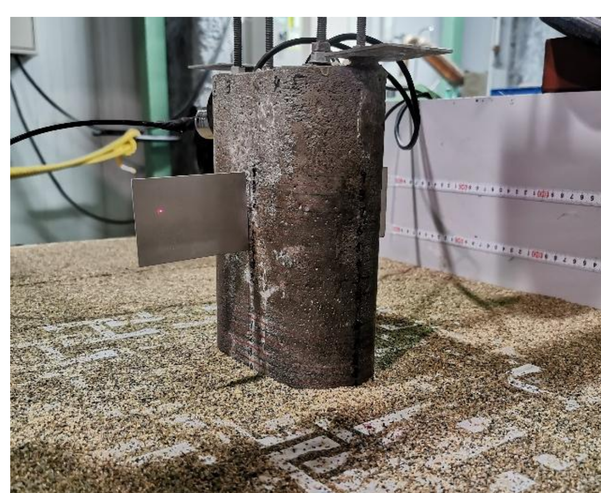
モルタル橋脚とさや型ブロックが敷設された様子 透明橋脚とビデオカメラ
